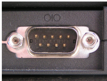
Abbildung: RS-232 über Sub D-9 Buchse
