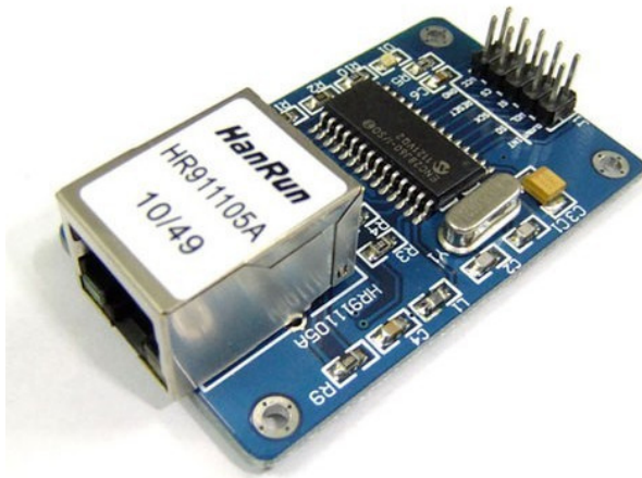
Abbildung: Ethernet mit Microchip ENC28J60
